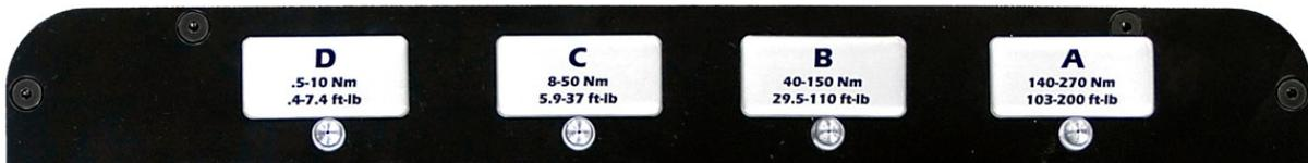
**Nota:** Las herramientas de poder requieren rotación antes de alcanzar el torque para la medición adecuada. El simulador de juntas provee un Angulo de rotación consistente para probar las herramientas de poder.
